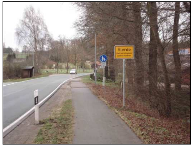
Bild 21: Übergang eines außerörtlichen benutzungspflichtigen gemeinsamen Geh- und Radweges in die Regelung „Gehweg /Radverkehr frei“ in Höhe der Ortstafel mit ungesichertem Einfahren auf die Fahrbahn ortseinwärts und ungesichertem Queren in der Gegenrichtung ortsauswärts zum Erreichen des benutzungspflichtigen Radweges
